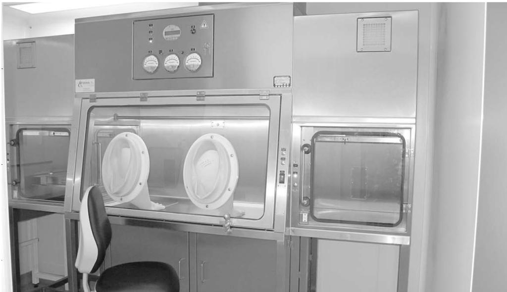
**Isolateur utilisé pour le remplissage en liquide hydraulique de la prothèse**
